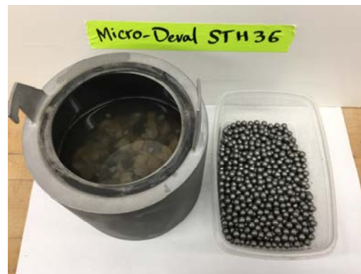
(d) Micro-Deval test container and charge
