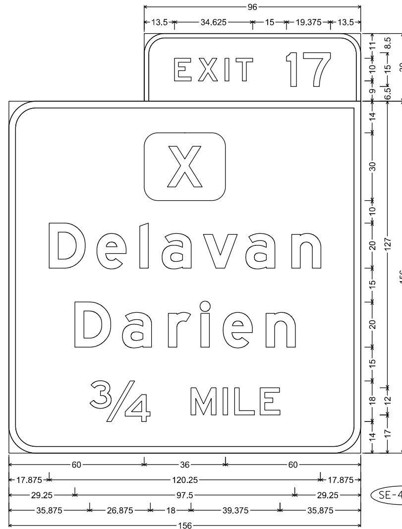
E1-5P; 9.000" Radius, 2.000" Border E1-1A; 12.000" Radius, 3.000" Border
