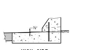
HIGH SIDE CONCRETE BARRIER DETAIL
