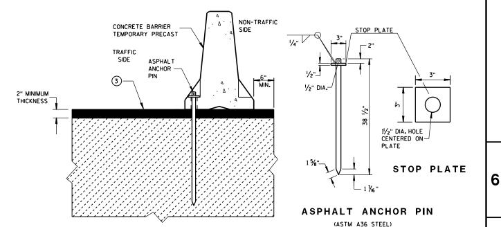
STAKE DOWN INSTALLATION FOR **ASPHALTIC SURFACE**
