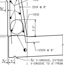
CONSTRUCTION JOINT STRIKE OFF AS SHOWN.
